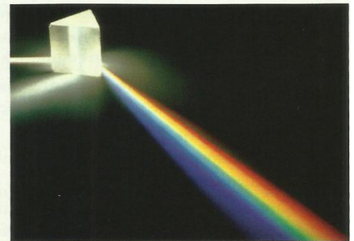
Doc. 15 Les radiations violettes sont plus déviées par le prisme que les radiations rouges.
